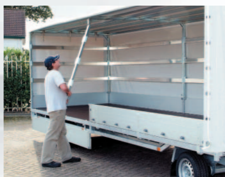
▲ De huif is rondom te openen en de middenpaal is uitneembaar
