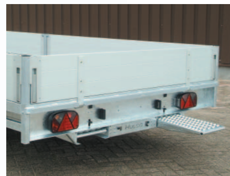
▲ De rijplaten worden onder het chassis in rijplaathouders opgeborgen
